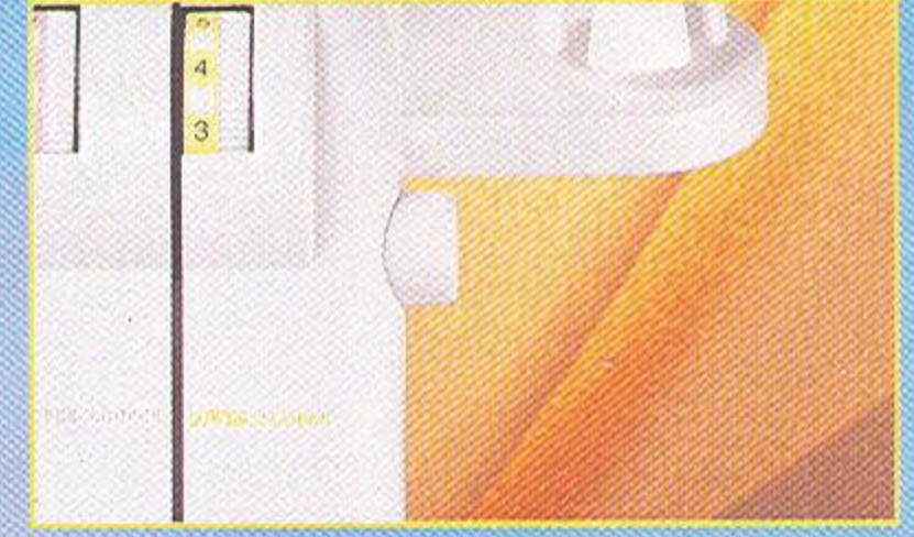
Slabirea Tensionarii firelor: Asigurativa ca toate cele 4 fire sunt introduse printre discurile talerelor. Deasemeni puteti scoate bucata lucrata fara sa detensionati firele de ata.
