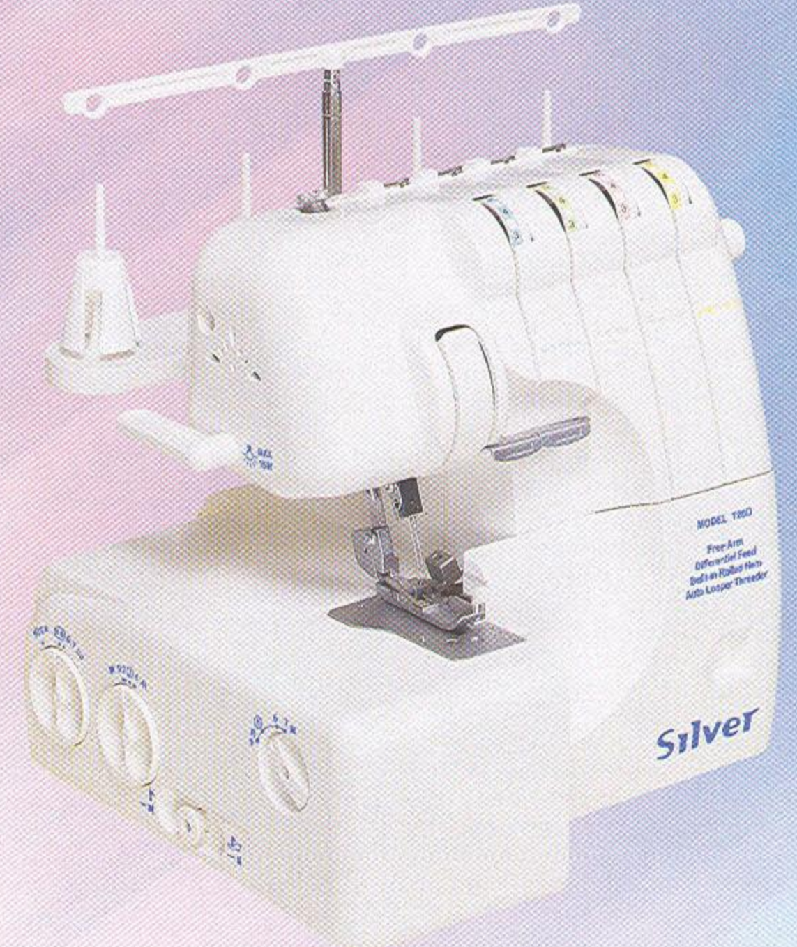
Deasemenea: Cadru interior din aluminiu usor Utilizeaza ace HAx1 sau 130/705H(12/14) Viteza de coasere 1250 RPM 1,1 - 4,0mm Lungimea Pasului 2,3 - 7,0mm Latimea Pasului Greutatea masinii : 7,0Kg.
